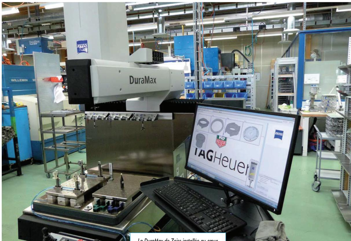
La DuraMax de Zeiss installée au cœur de l'atelier de l'entreprise TAG Heuer. La machine a notamment été choisie pour la stabilité thermique des mesures.
